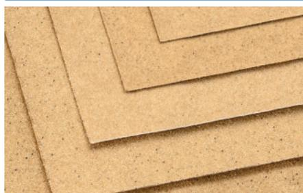
Flint-Schleifpapier optimal geeignet für Trockenschleifarbeiten an Oberflächen im Innen- und Außenbereich. Flint-Schleifpapier ist insbesondere für Holz, Metall, Lacke und Kunststoff geeignet. Grobe Körnungen (K40-80) zum Grobschliff oder zur Entfernung von Lack- und Leimschichten, mittlere Körnungen (K80-120) zum Zwischenschliff und Vorschleifen roher Holzoberflächen und feine Körnungen (180-240) für den Feinschliff.
