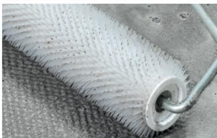
11 mm-Dornen aus lösungsmittelbeständigem Kunststoff zum Aufstechen von Luftblasen, die beim Einsatz verschiedenster Bodenbeschichtungs-Materialien entstehen und vor dem Abbinden entfernt werden müssen, um Folgeschäden bzw. auch Nacharbeiten frühzeitig zu vermeiden und eine ebene Bodenfläche zu erhalten.
