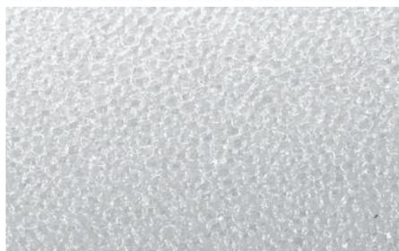
Universelle Schaumwalzen mit mittlerem Raumgewicht und geringer Stauchhärte zur Herstellung einfacher Lackierungen.
