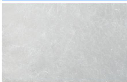
Für einfache Beschichtungen und Einmaleinsatz. Gut geeignet für bitumenhaltige Anstriche, Glasfaserkunststoffen und zum Einsatz in Bereichen mit geringen Anforderungen an optische Güte.
