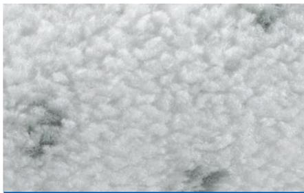
Kurzfloriger, gewebter Microfaserplüsch auf Basis einer Polyester-Endlosfaser. Dichter Plüsch mit hohem Raumgewicht und besonders hoher Materialaufnahme. Gleichmäßige Farbaufnahme und hervorragende Materialabgabe für Parkettlacke, Öle und wasserverdünnbare Lacke.
