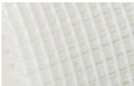
Zur Rissüberbrückung im Trockenbau. Selbstklebendes Gitterband in Kantenstoß einlegen und einspachteln. Feine Maschung für besondere Stabilität und Verbindung von Kantenstoß-Gitterband-Spachtel.
