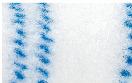
Sehr kurzfloriger, hochtexturierter Polyamid-Endlosplüsch mit besonders standfestem Faden. Entwickelt zur Verarbeitung von Epoxidharzen in geringen Auftragsmengen, Speziallacken und Parkettversiegelungen auf Kunstharzbasis. Auch geeignet zur Verarbeitung von Teppichkleber.
