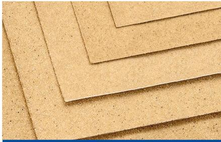
Schleifpapiere sind optimal geeignet für Schleifarbeiten an Oberflächen im Innen- und Außenbereich. Grobe Körnungen (P40-80) zum Grobschliff oder zur Entfernung von Lack- und Leimschichten, mittlere Körnungen (P80-120) zum Zwischenschliff und Vorschleifen roher Holzoberflächen und feine Körnungen (P180-240) für den Feinschliff, bzw. extra feine Körnungen für den Nassschliff mit wasserfesten Schleifpapieren.
