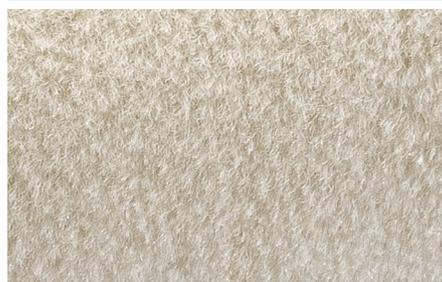
Hochwertiges Naturprodukt aus gewebter Lammwolle zur Verarbeitung von lösemittelhaltigen Lacken und Glasfaser-Kunststoffen.
