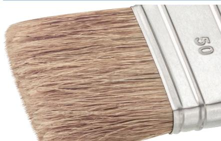
Reine Naturborste, einmal gekocht, 60 % Tops. Ideal für lösemittelhaltige Lacke, Beschichtungen, Dispersions- und Latexfarben. Weniger für wasserlösliche Acryllacke geeignet, da Naturborsten quellen. Nicht geeignet für fettlösende und alkalische Materialien.
