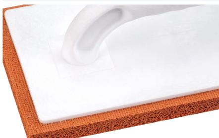
Reibebretter zum Glätten und Abreiben frisch aufgetragener Putze und Estriche. Durch das Reiben entsteht eine gleichmäßige Oberfläche, sowie eine erhöhte Festigkeit der Masse. Verschiedene Reibeputze und Scheibenputze lassen sich ebenso verarbeiten wie Filzputze.
